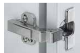
Угол корпуса 90° Фасад 14 – 28 мм Угол открывания 95° Intermat 9936 W90
