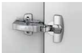
Угол корпуса 20° Фасад 15 – 32 мм Угол открывания 95° Sensys 8631i
