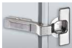
Угол корпуса 45° Фасад 14 – 32 мм Угол открывания 95° Intermat 9936 W45
