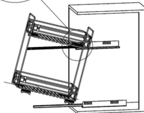
3.4 Отрегулировать крепление к направляющим в задвинутом состоянии. Одеть фасад. Отрегулировать во всех плоскостях. По окончании, зафиксировать фасад, затянуть все винтовые соединения
